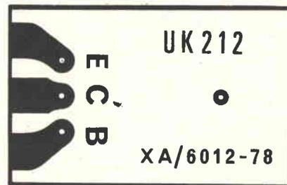
Fig. 3 - CSI dove verrà effettuato l'ancoraggio dei reofori del transistor di potenza.
